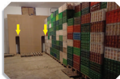
روش صحیح چینش میوه ها و موقعیت کانال های مکش هوا
